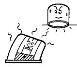
温度の高くなるもの（ガスレンジやエアコンの吹き出し口など）の近くに設置しないでください。
