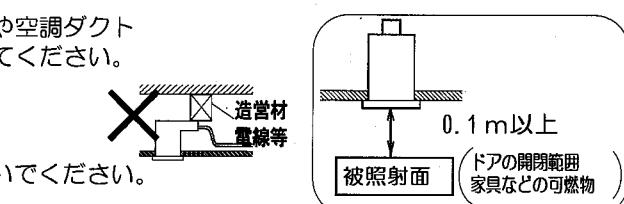
一住宅以外の断熱施工天井でご使用の場合の施工方法
