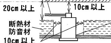
断熱材・防音材で本体の放熱孔穴等をふさがないでください。
