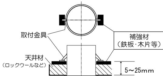
ロックウールなどの軟らかい材料を使用している天井に取り付ける場合には、必ず取り付け金具と天井材の間に補強材(鉄板・木片等)を入れてください。
