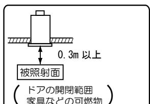
一住宅以外の断熱施工天井でご使用の場合の施工方法
