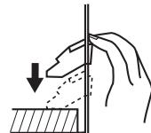
※ DD-3238も取付時にはヒートシンクを垂直にして取付してください。
