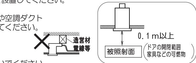
—住宅以外の断熱施工天井でご使用の場合の施工方法—
