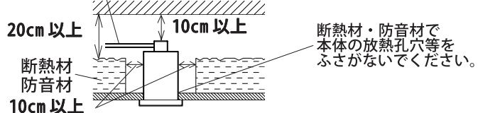
温度の高くなるもの(ガスレンジやエアコンの吹き出し口など)の近くに設置しないでください。
