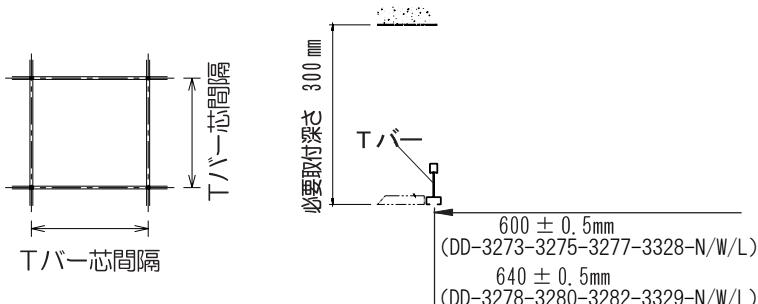
2. Tバーが固定金具に対応した寸法になっている事を確認の上取付けてください。
