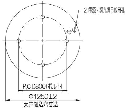
②取付ボルトはレースウェイ等を使用して必ず垂直に降ろしてください。
