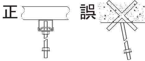
③取付ボルトの長さを調整してください。天井面からボルトの先端まで200±5mmです。
