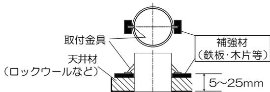
ロックウールなどの柔らかい材料を使用している天井に取り付ける場合には、必ず取り付け金具と天井材の間に補強材(鉄板・木片等)を入れてください。
