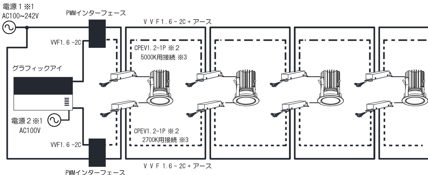
※1：電源1及び2は必ず同一分電盤の分岐ブレーカーに接続のうえ、アースも接続してください。
