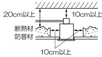
電気配線は断熱材・防音材の上側にくるよう配線してください。
