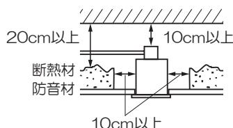
電気配線は断熱材・防音材の上側にくるるように配線してください。
