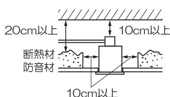
電気配線は断熱材・防音材の上側にくるように配線してください。
