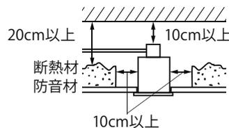
電気配線は断熱材・防音材の上側にくるように配線してください。
