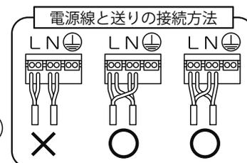
**警告** 端子台に差し込むケーブルは、必ずVVFφ1.6またはφ2.0の単線ケーブルで真っ直ぐな線を使用してください。
