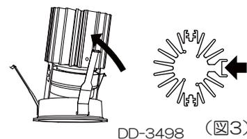
【DD-3494・3495・3498の水平角度調整方法】
