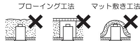
住宅以外の断熱施工天井でご使用の場合の施工方法
