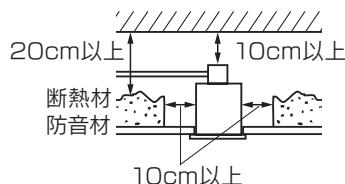
電気配線は断熱材・防音材の上側にくるよう配線してください。
