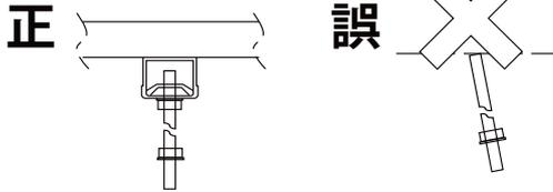
※傾斜したボルトはボルト受金具に無理な力がかかり、器具変形の原因となります。
