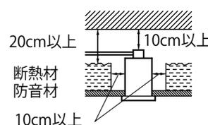
電気配線は断熱材・防音材の上側に
