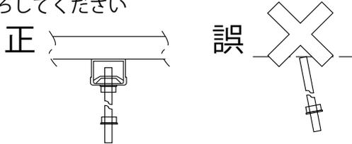
※傾斜したボルトはボルト受金具に無理な力がかかり、器具変形の原因となります。
