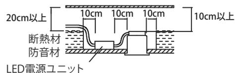
電気配線は断熱材・防音材の上側にくるように配線してください。（器具本体に電源線を接触させないでください。）
