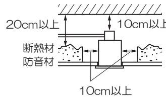
電気配線は断熱材・防音材の上側にくるように配線してください。
