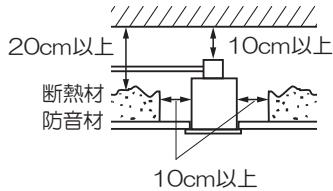
電気配線は断熱材・防音材の上側にくるよう配線してください。
