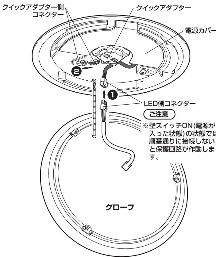
**注意** ※壁スイッチON(電源が入った状態)の状態では、順番通りに接続しないと保護回路が作動します。
