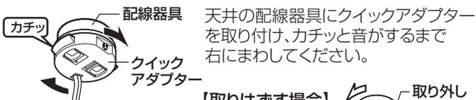
天井の配線器具にクイックアダプターを取り付け、カチッと音がするまで右にまわしてください。
