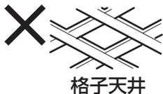
**警告** 下記のような配線器具には取り付けられません。火災、感電、落下によるけがの原因となります。
