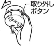
**注意** 取り外しボタンを押さずにまわすと配線器具を破損します。
