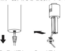
①フランジ固定 ナットを緩め フランジ固定 ナットと、フラン ジを静かに本体 まで下ろします。
