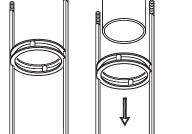
6. カバーをセットます。 ●カバーの取付け方 ②ネジを支持金具に通しローレットナットで
