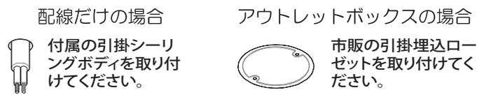
**警告** 配線器具は、必ず補強材のある場所に取り付けてください。
