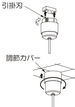
②コード調節引掛けシーリングキャップの調節カバーが天井面、または配線器具にあたるまで時計方向に回してください。
