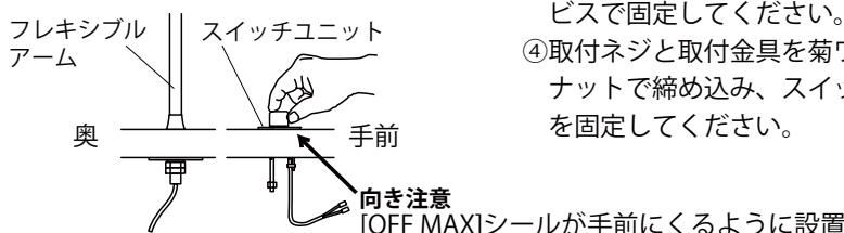
②裏からスイッチユニットの取付ネジに取付金具を差し込みます。
