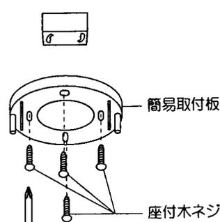
取付板を付属の座付木ネジ (4本) で補強材のある位置にしっかりと取り付けてください。
