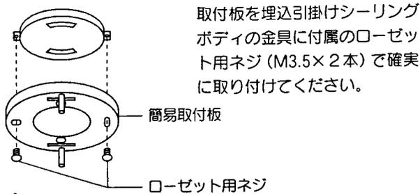
取付板を埋込引掛けシーリングボディの金具に付属のローゼット用ネジ (M3.5×2本) で確実に取り付けてください。
