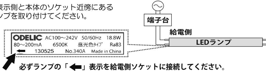
必ずランプの「←」表示を給電側ソケットに接続してください。
