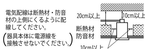
断熱材・防音材で本体の放熱孔穴等をふさがないでください。
