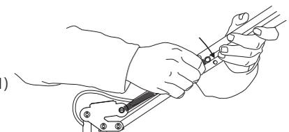
(図1) スプリングの一方の輪を中間ジョイントのスプリングフックの溝に引掛けます。
