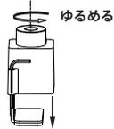
① クランプの上ハンドルを矢印の方向に回し設置する場所の厚みより広くなるようにセット金具を緩めます。
