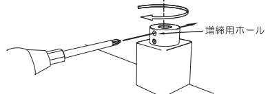
図の様にドライバーなどを増締用ホールに差し込み右回転で回しめつけてください。締めすぎると取付面が傷ついたり、クランプの破損などの原因になります。
