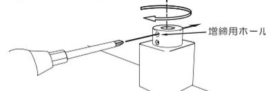
図の様にドライバーなどを増締用ホールに差し込み右回転で回し締めつけてください。締めすぎると取付面が傷ついたり、クランプの破損などの原因になります。
