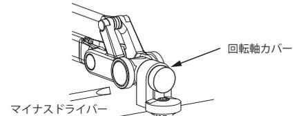
(2) 六角穴ネジを付属のL型レンチで締めます。調節が終わったら、回転軸カバーを戻してください。
