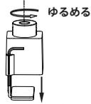
①クランプの上ハンドルを矢印の方向に回し設置する場所の厚みより広くなるようにセット金具を緩めます
