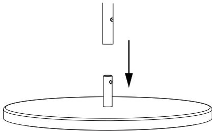
③ パイプのネジ孔とベース中央から出ている差込金具のネジ孔の位置を合わせてパイプを差し込みます。
