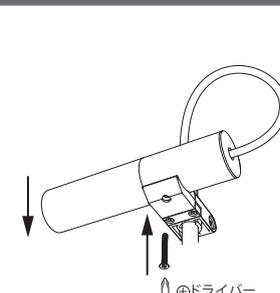
3) 1) で外したネジを使ってシェードを固定します。
