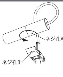
2) シェードを反転させ、シェードのネジ孔Aとネックのネジ孔Bの位置を合わせます。
