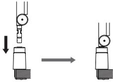
2) ACアダプタープラグとDCジャックを差し込み接続します。
