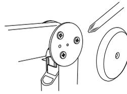
2) ジョイントカバーの中のネジをプラスドライバーで調節し、ジョイントカバーを元に戻します。
