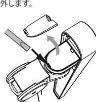
3) 矢印の位置のネジをプラスドライバーで調節します。
