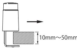
3) クランプの上ハンドルを矢印の方向に回しセット金具を締めこみます。
