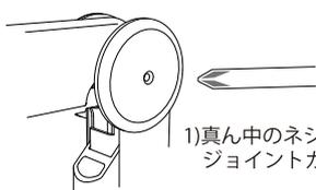
1) 真ん中のネジをプラスドライバーで外し、ジョイントカバーを外します。
